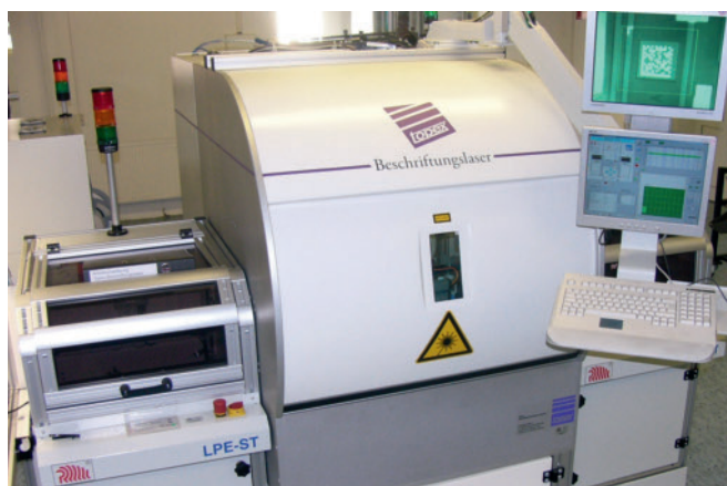
Bild 2. Lasermarkiersystem mit integriertem Etikettendrucker
