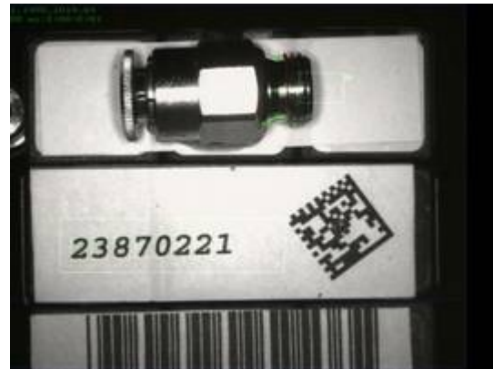
hier fehlt die Dichtung (Fenster wird rot dargestellt)
